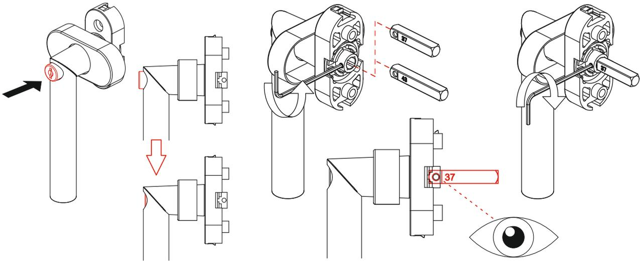
Schrauben in die Fenstergriff-Unterkonstruktion einführen und den Fenstergriff auf den Fensterrahmen aufstecken. Anschließend kann der Griff mit den Schrauben in geeigneter Länge angeschraubt werden.
