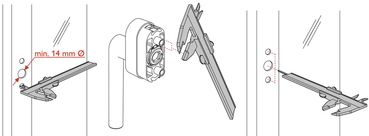
Mit der Tiefenmessung sollte die Länge der Schrauben und des Stiftes bestimmt werden.
