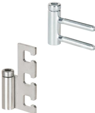
Hermai Glastürbänder sind sowohl in 2 teiliger wie auch in 3 teiliger Ausführung lieferbar. Bei allen Aluminium und Edelstahl Bändern werden Spezial - Klemmunterlagen verwendet, welche für einen sicheren Halt sorgen und ein absinken absinken der Türe verhindern.
